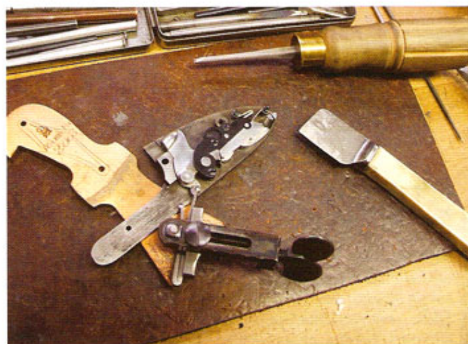
Auch ein Mann fürs Feine: Ausbau einer Seitenschloss-Schlagfeder.
