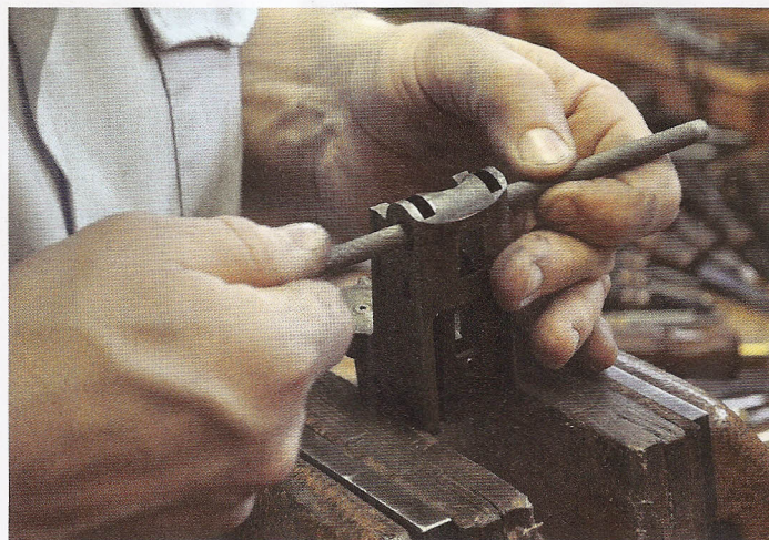
Das Lager wird für einen neuen Bolzen vorbereitet und geringfügig nach hinten verschoben.
