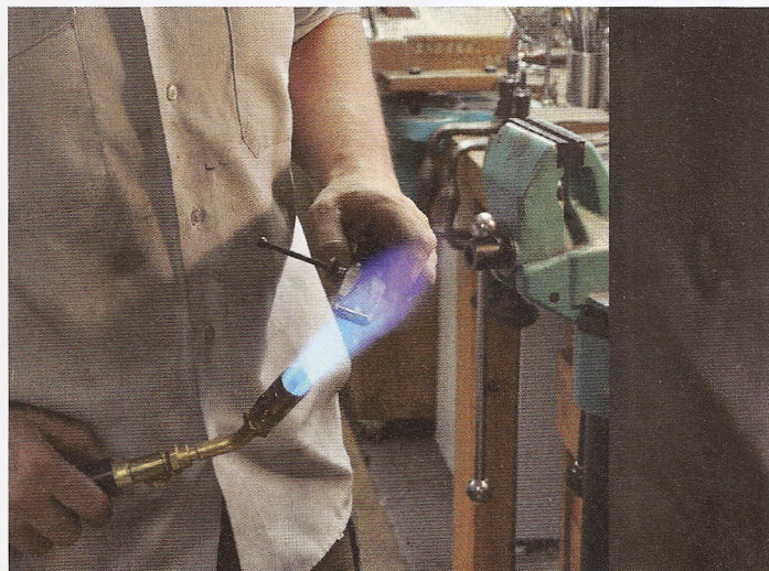
Der neue Bolzen wird gegläht und gehärtet.
