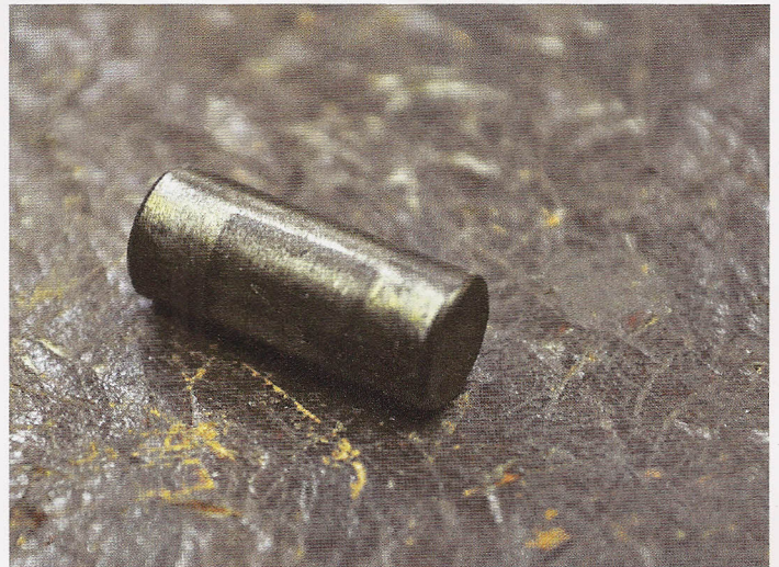
Deutlich zu sehen: Gebrauchsspuren am alten Scharnierbolzen.
