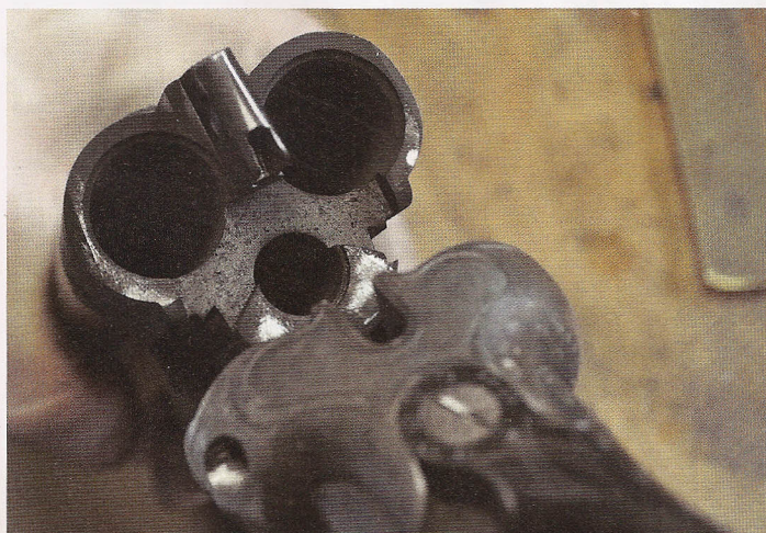
Immer wieder überprüft der Fachmann die Dichtung mit Russ.
