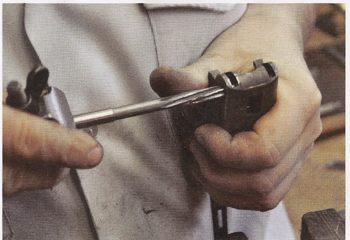
Deutlich zu sehen: Gebrauchsspuren am alten Scharnierbolzen.
