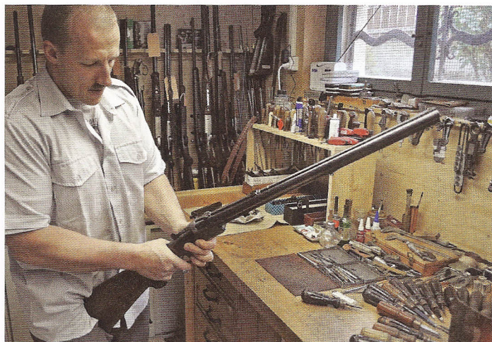
Büchsenmacher Peter Kammermann bereitet einen Drilling zum Abdichten vor.
